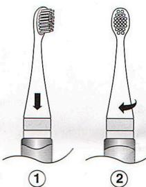
Установите насадку на рукоятку совмещая направляющие на насадке и рукоятке. Зафиксируйте насадку на рукоятке, повернув ее до упора по часовой стрелке, как показано на рисунке. Для того чтобы снять насадку, необходимо проделать те же действия в обратном порядке.
